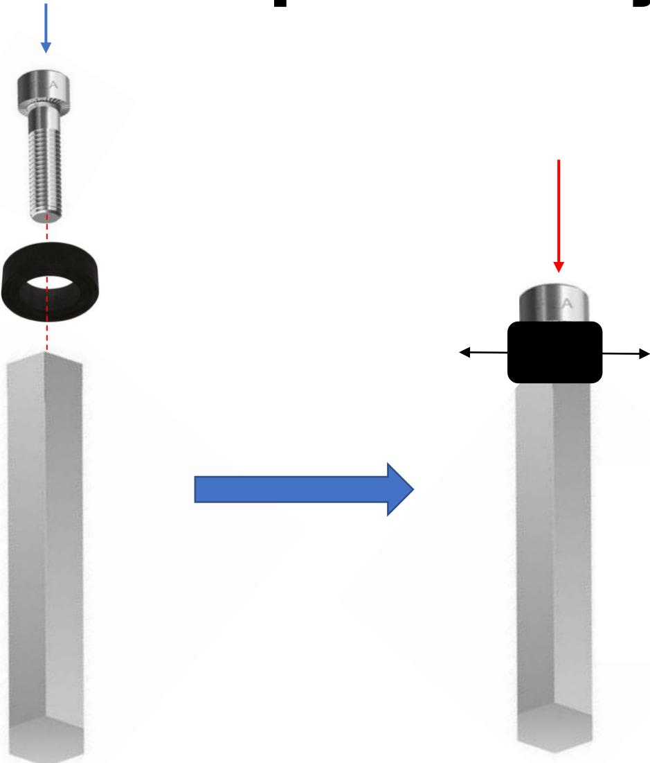
En serrant la vis de compression le diamètre de l'anneau Caoutchouc augmente ce qui permet lors de l'insertion de la manœuvre de secours dans le moteur d'empêcher sa chute lors de l'utilisation. Une fois la fermeture du store effectuée, tirer sur la manœuvre de secours pour la libérer de son logement.
